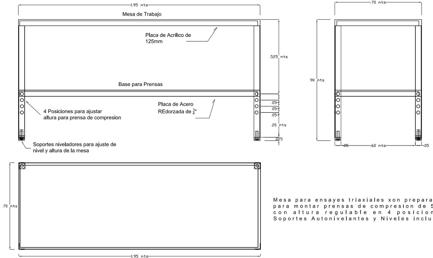
Mesa para ensayes triaxiales con preparacion para montar prensas de compresion de 50kN con altura regulable en 4 posiciones. Soportes Autonivelantes y Niveles incluidos
